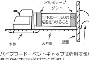
パイプフード・ベントキャップは強制排気用のものを必ず取り付けてください
