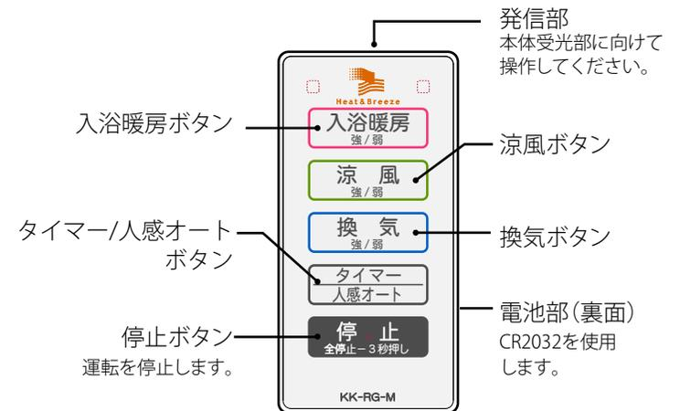
リモコン (KK-RG-M) を2台ご使用の場合片方のリモコンのチャンネルを変更することができます。
