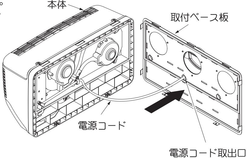
2. 取付ベース板のツメ（3カ所）に本体を差し込み、壁面方向に押し、本体固定ねじに本体を納める。
