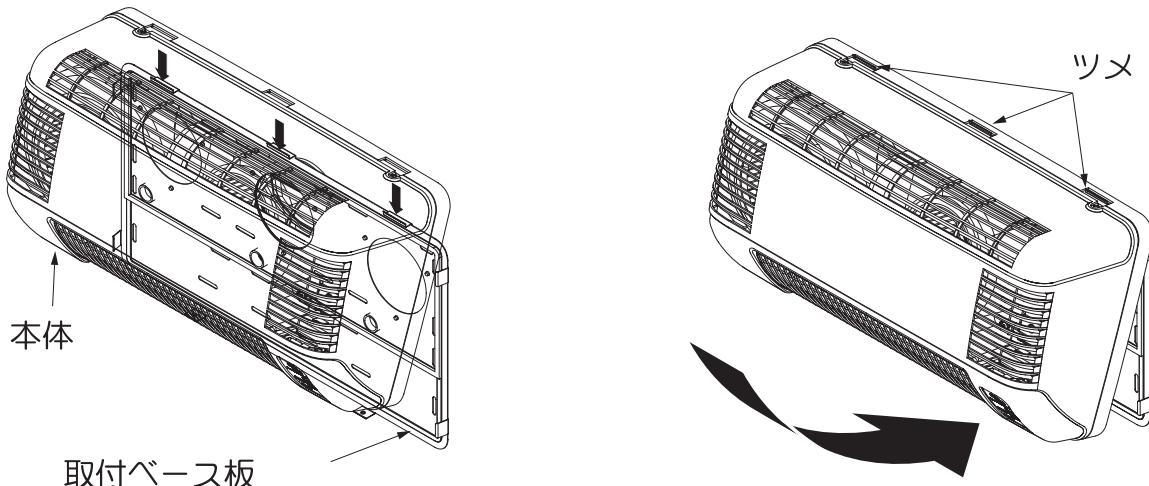
3. 本体固定ツマミねじ（2カ所）を増締めして本体を固定する。
