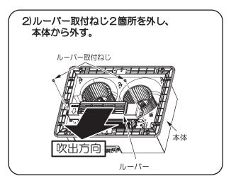
3)ルーバーの向きを180° 回転させ本体にセットし、 取付ねじで固定する。
