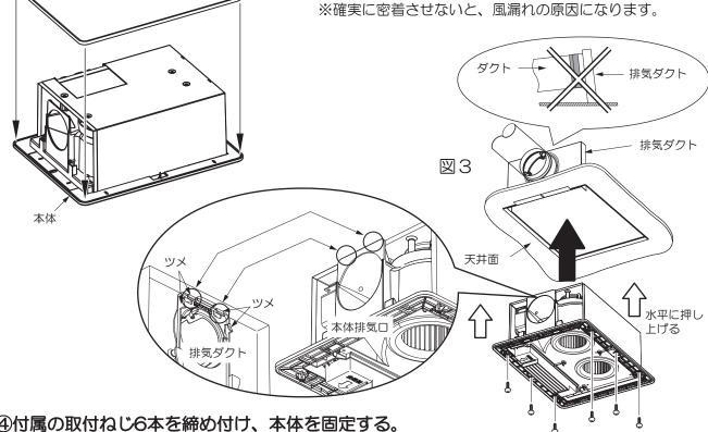
④付属の取付ねじ6本を締め付け、本体を固定する。
