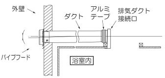
ダクトは必ず屋外側に下り勾配(1/100~1/50)を設けてください。雨水の浸入や結露水の逆流の原因になります。
