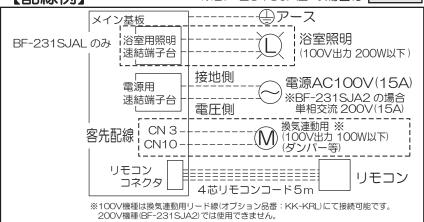
配線コード(VVFケーブル: ø1.6mm/2.0mm) AC100V リモコン 50/60Hz コネクタ → 🖶 アース ( D 種接地工事) **)** ・ドクランプ固定ねじ コードクランプ |芯リモコン |エド-5m 電源端子台 7-ス 🕏 🖶 配線カバーを開けるとき ①コードクランブを外す。 ② 2 箇所のねじを2~3 回転ゆるめる。(外さない) ③配線カバーを上に持ち上げる。
