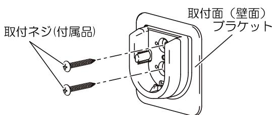
注) 取付面(壁面)がコンクリート・タイル仕上げ等、取付ネジが使用出来ない場合は、カールプラグ(市販品)等を使用して取付を行ってください。
