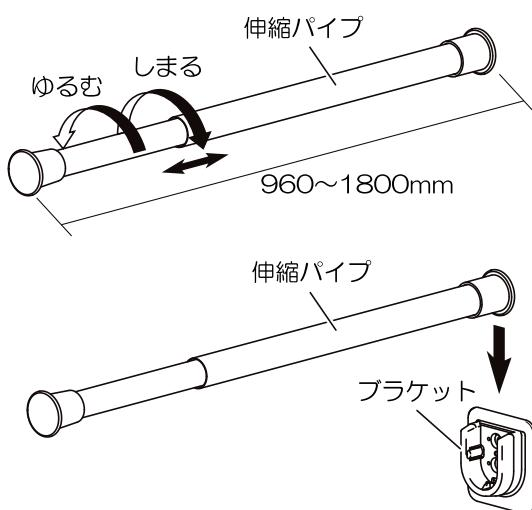
※最後に必ずブラケットの抜け止め(ツメ)にパイプキャップが引っかかっていることを確認してください。
