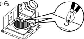
●排気ダクトが傾いていますと、本体が取付けられないので注意してください。(図2)
