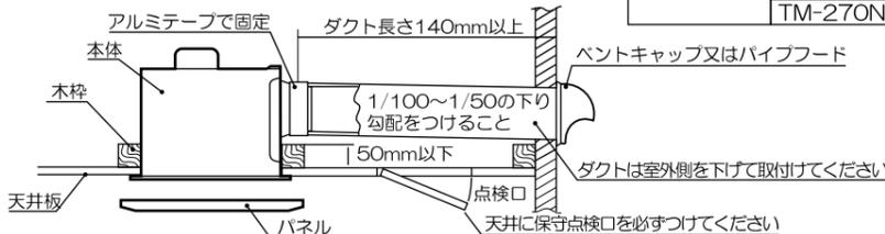
**注意** 排気ダクト先端にパイプフード・ペントキャップの防虫網付(細目)は絶対に使用しないでください。
