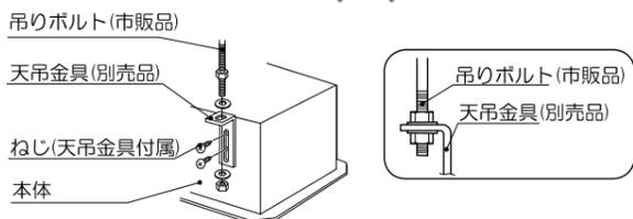
注) アンカーボルト工事をしてから天吊金具(別売品)を使って固定してください。
