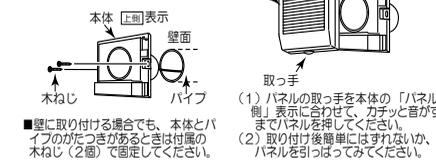
■壁に取り付ける場合でも、本体とパイプの間に隙があるときは付属の木ねじ（2個）で固定してください。
