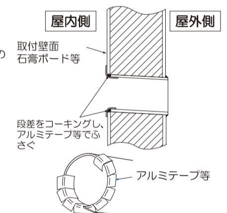
注）石膏ボードに取り付ける場合は、下地木桟に固定するか、市販の石膏ボード用アンカーを必ず使用して固定ください。
