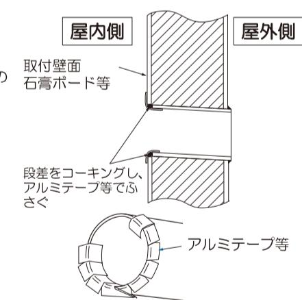
注）石膏ボードに取り付ける場合は、下地木枠に固定するか、市販の石膏ボード用アンカーを必ず使用して固定ください。
