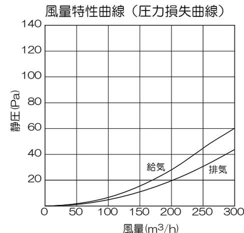
塩ビ管φ150×750mm装着時の風量試験
