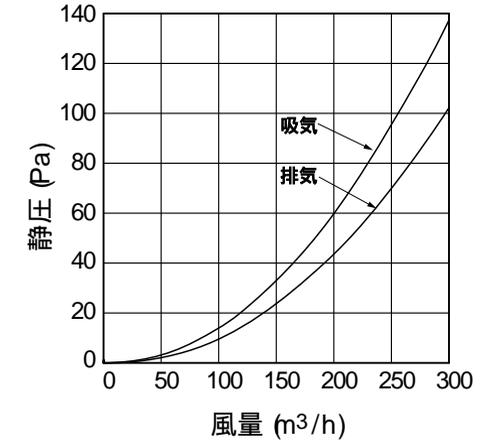
塩ビ管 100x 500mm装着時の風量試験
