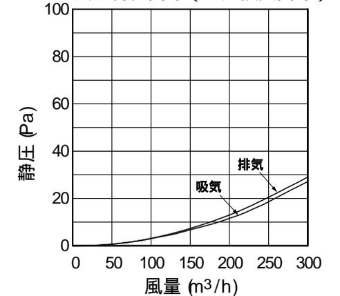
塩ビ管 150x 750mm装着時の風量試験
