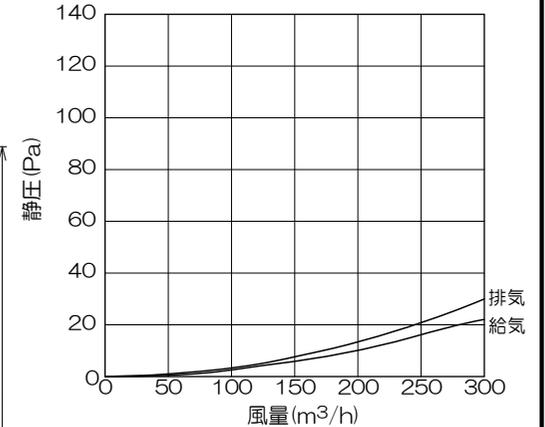
塩ビ管φ150×750mm装着時の風量試験
