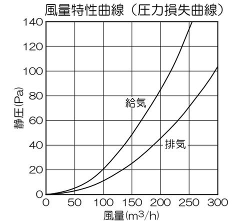
塩ビ管φ100×500mm装着時の風量試験
