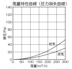
塩ビ管 φ 150×750mm装着時の風量試験 局部圧力係数(ξ) 2.29(排気) 3.96(給気)
