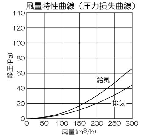
塩ビ管 φ150×750mm 装着時の風量試験
