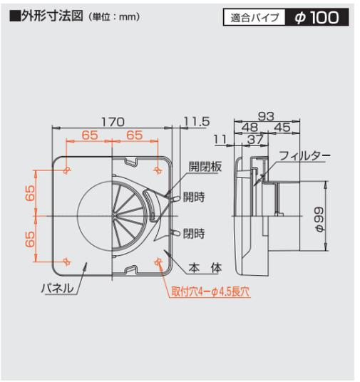
壁用同時給排気形換気扇
