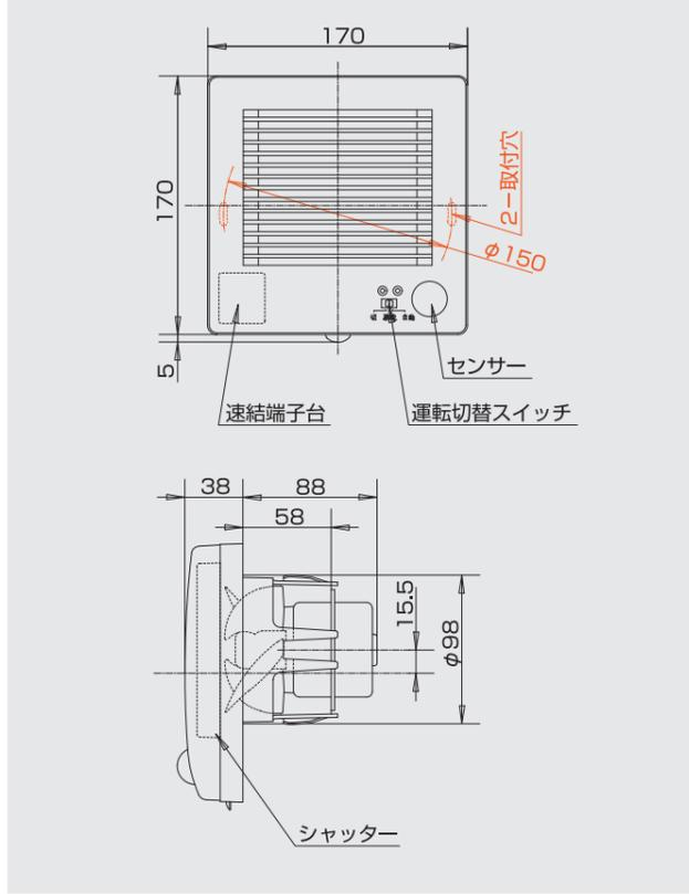
強制排気用  $\phi 100$  パイプ用ファン【高密閉電気式シャッタータイプ】 トイレ
