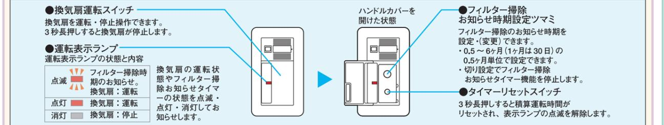
換気扇の運転時間を積算して、あらかじめ設定した時期がくると運転表示ランプが点滅してフィルターの掃除時期になったことをお知らせします。
