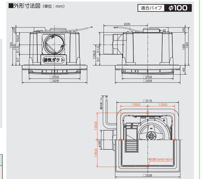
壁用同時給排気形換気扇
