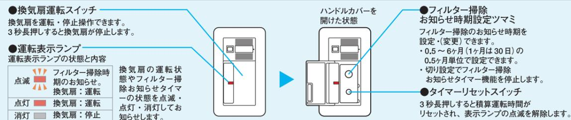
換気扇の運転時間を積算して、あらかじめ設定した時期が来ると運転表示ランプが点滅してフィルターの掃除時期になったことをお知らせします。
