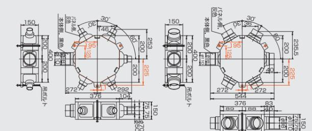
壁用同時給排気形換気扇
