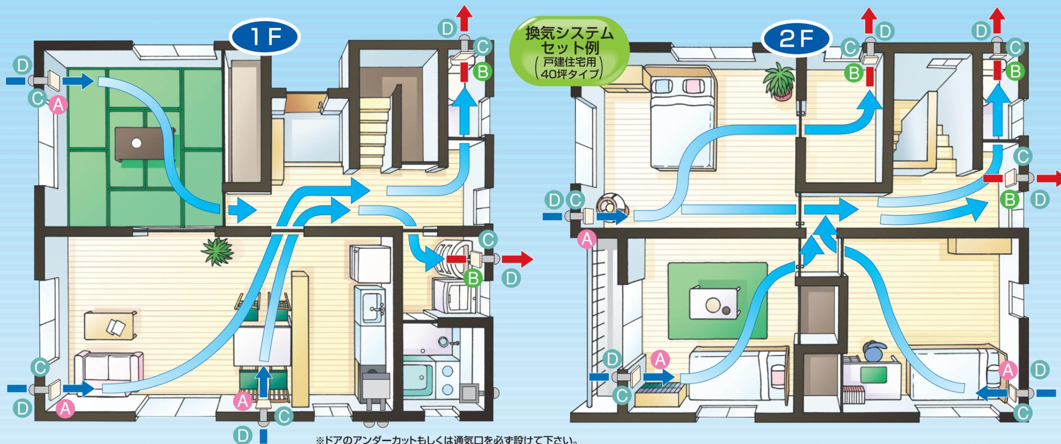
※ドアのアンダーカットもしくは通気口を必ず設けて下さい。
