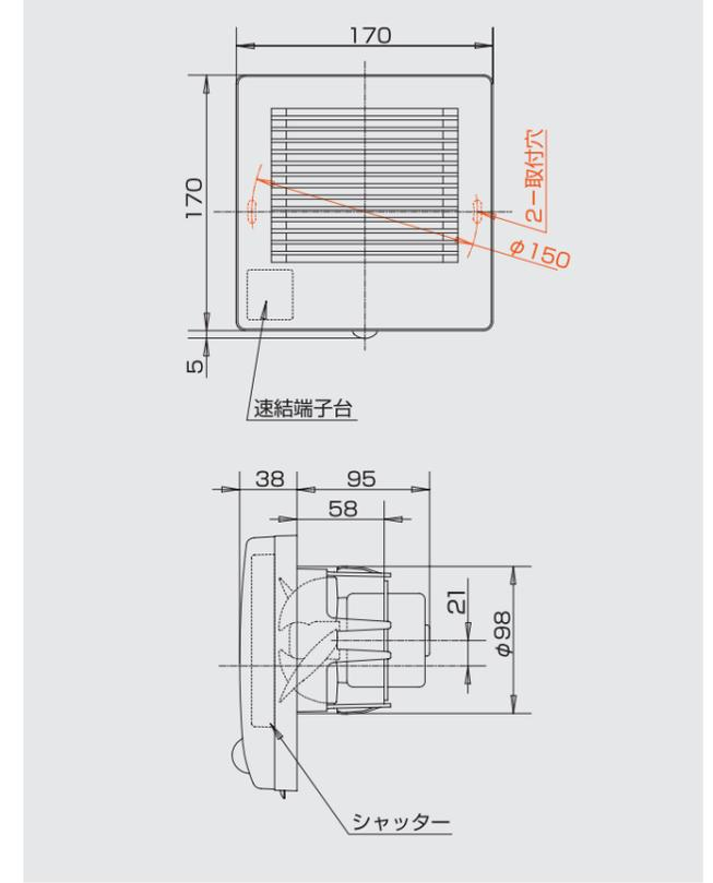
強制排気用  $\phi 100$  パイプ用ファン【人感センサー自動運転タイプ】 トイレ
