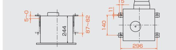
強制排気用  $\phi 100$  パイプ用ファン【人感センサー・高密閉電気式シャッタータイプ】 トイレ
