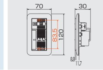
壁用同時給排気形換気扇
