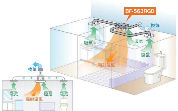
※トイレ換気端子に、既設のトイレ・脱衣室の換気スイッチを連動することにより、従来と同じ使用方法となります。
