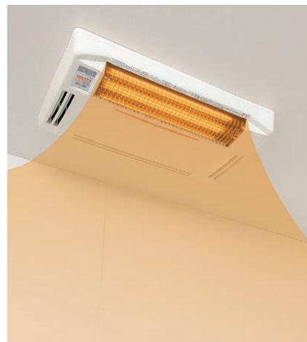
暖房運転中は電動ダンパーが閉まり浴室からの24時間連続換気を停止し、入浴中の肌寒さを軽減。24時間運転は脱衣室・トイレから必要量の換気を行います。
