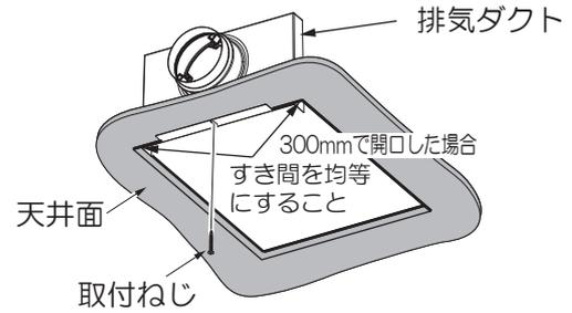
②ダクト接続口にダクトを接続して、風漏れのないようにアルミテープを巻いて固定する。
