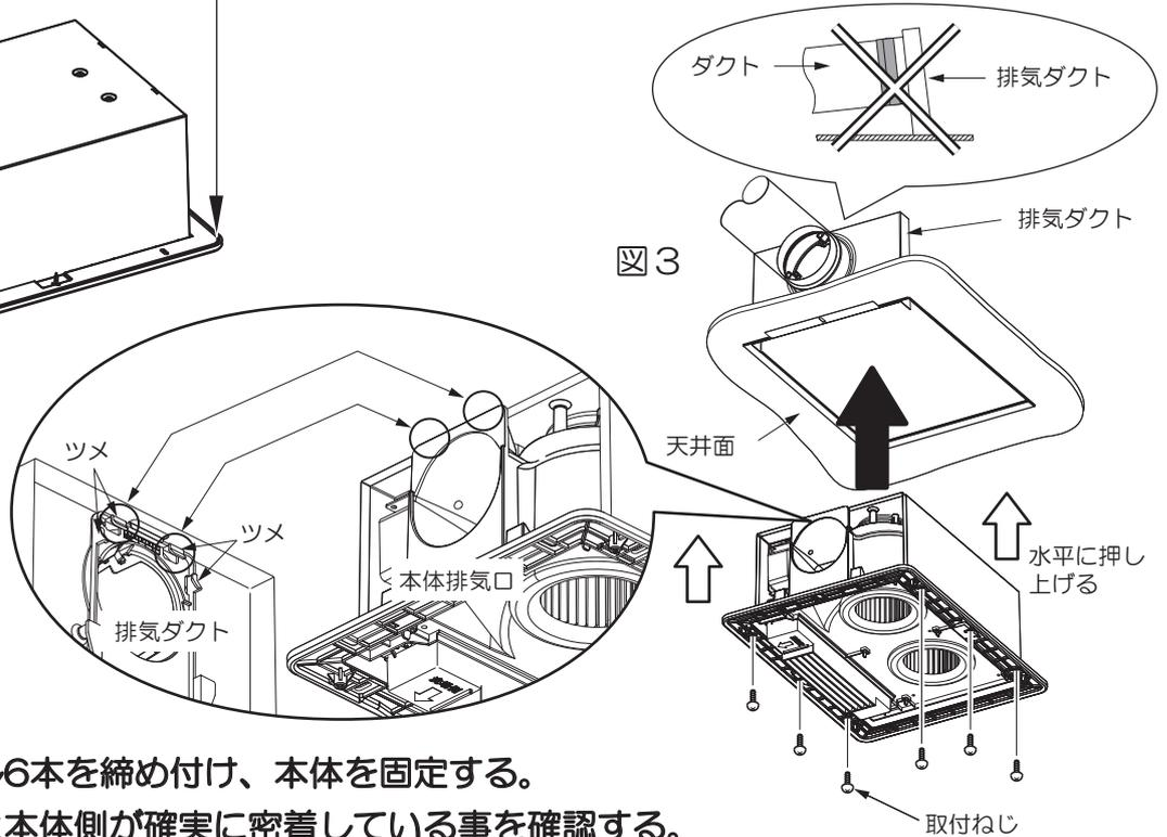
④付属の取付ねじ6本を締め付け、本体を固定する。
