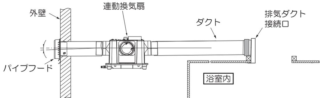
ダクトは必ず屋外側に下り勾配(1/100~1/50)を設けてください。雨水の浸入や結露水の逆流の原因になります。
